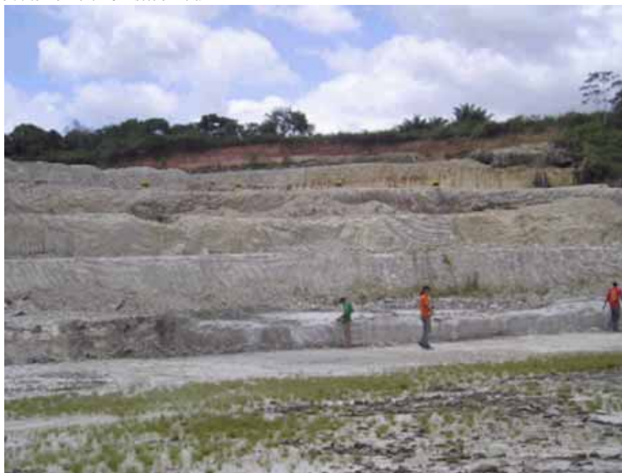
Figura 3 – Mina B-17: parte de sua seção colunar, onde se observam bancadas abertas para a exploração do calcário. Trata-se de biocalcarenitos não estratificados, arenitos finos e calcários. Figure 3 - Mine B-17: part of the geologic section on the mine walls opened to limestone exploration, exposing massive fossiliferous carbonatic sandstones fine-grain sandstones and limestones.
