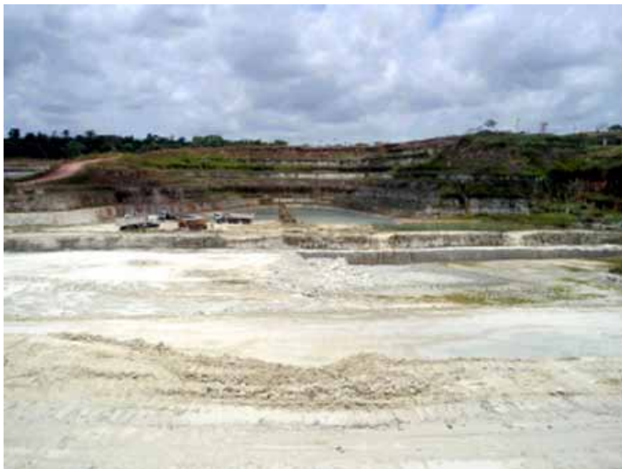
Figura 2 - Vista geral da Mina B-17, mostrando parte da seção carbonática e arenitos no topo, ao fundo, enquanto os níveis abaixo cinza claros, correspondem a algumas das litofácies carbonáticas, do total de cerca de 20m da seção completa. Figure 2 - General view of Mine B-17, showing part of the carbonatic section and sandstones (top, on the back). The pale gray levels correspond to different carbonatic lithofacies from the 20m section left.
