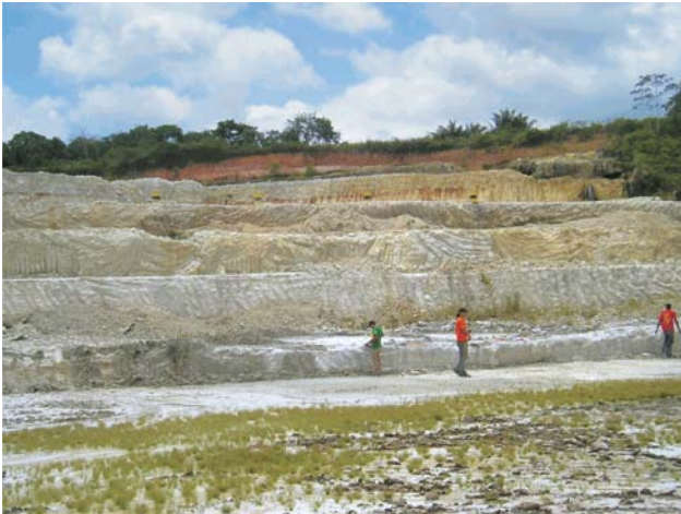
Figura 3 - Mina B-17: parte de sua seção colunar, onde se observam bancadas abertas para a exploração do calcário. Trata-se de biocalcarenitos não estratificados, arenitos finos e calcários.
